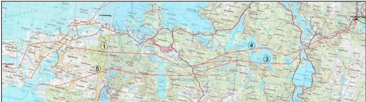
**Figur 1.** Alternative traséer for 132 kV ledningen mellom Hålandsfossen og Lutelandet. Alt. 5 har frafalt bl.a. pga. opplagte konflikter i forhold til friluftsjakter og landskapsverdi.
