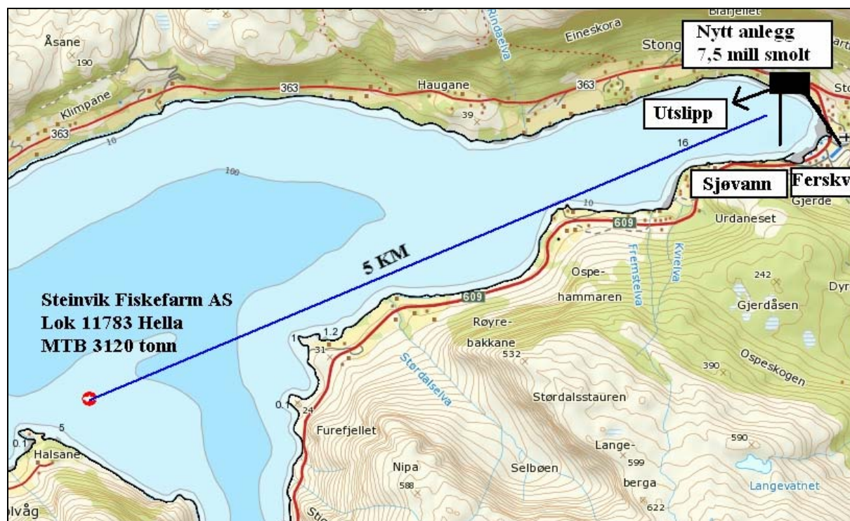
Figur 16. Det nye settefiskanlegget innerst i Stongfjorden (svart rektangel) med planlagt utslipp og inntak for sjøvann inntegnet og nærliggende akvakulturvirkosomhet i Stongfjorden. Matfiskankegg laks er rød (fra www.fiskeridir.no ).
