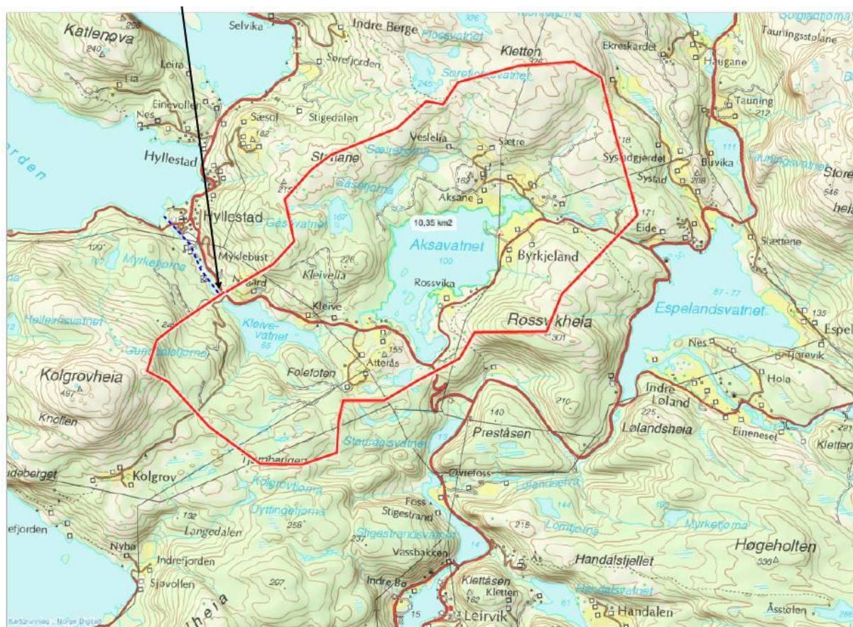
**Figur 4.** Myklebostelva i Hyllestad sitt nedbørfelt. Pilen viser planlagt innløp til røyrleidninga som skal samle vatnet til kraftverket.
