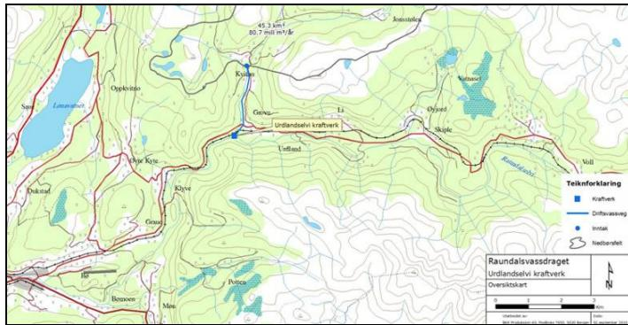
**Figur 6.** Skisse over Urdlandselvi småkraftverk på nordsida av Raundalselva.
