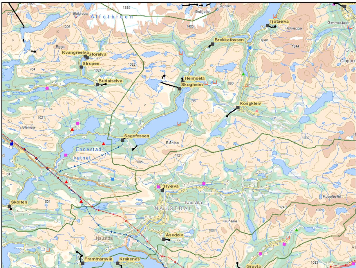
**Figur 25.** Kraftleidningar og vasskraftverk kring planlagt 132 kV leidning Gjengedal-Storebru som er utbygde (svart), under bygging (blå), konsesjonssøkte (raud), fritekne for konsesjon (rosa) og potensielle (grøn) (kjelde: <http://arcus.nve.no/website/vannkraftverk/viewer.htm>).
