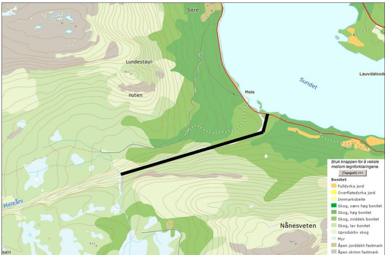
**Figur 11.** Boniteten langs Meleåni er middels i nedste parti og låg i midtre og øvste parti ([www.ngu.no/kart/arealisNGU](http://www.ngu.no/kart/arealisNGU)). Omtrentleg trasé for røyrgate er vist med svart line.
