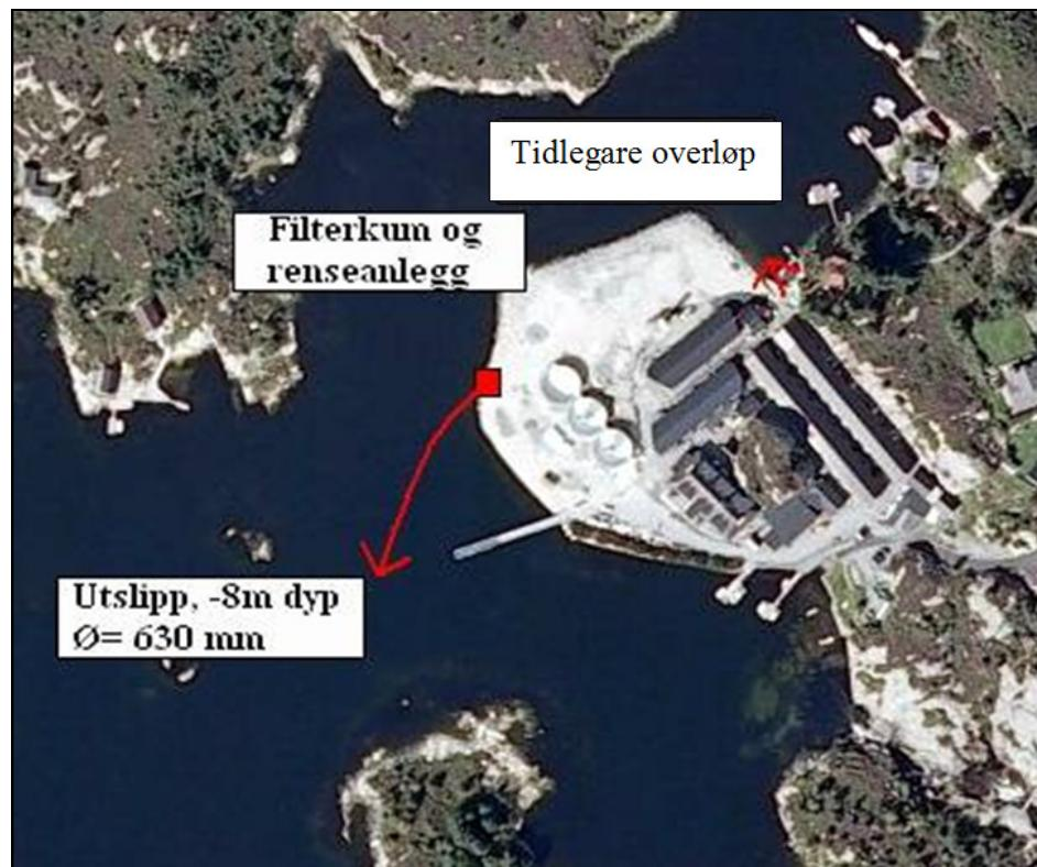
**Figur 3.** Skisse over anlegget til Sjøtroll Havbruk AS med tidlegare overløp, og tidlegare mellombels avløpsleidning for rensa overløpsvatn på 8 m djup sørvest for anlegget.
