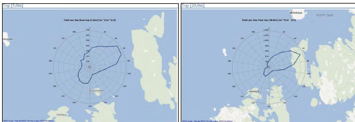
**Figur 5.** Oversikt over dominerande straumretning og flux/vasstransport på 5 m djup (venstre) og 20 m djup (høgre) ved anlegget. Figurar er henta frå Haveland 2013.
