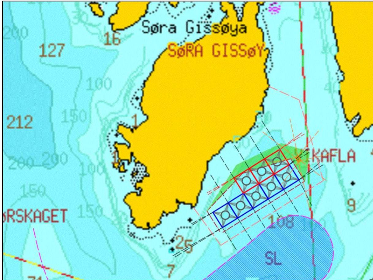
**Figur 1.** Anleggskonfigurasjon og lokalitetsområde for lokaliteten Gissøysundet med eksisterande anlegg (blått) og nyleg godkjent utviding (raudt). Figur er mottatt av oppdragsgjever.
