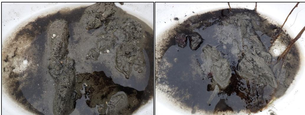
På stasjon **S2** fekk ein 14 m djup opp mellom  $\frac{1}{6}$  til  $\frac{1}{3}$  med grå og lukt fri prøve med mjuk til fast konsistens. Prøven bestod av skjelsand og sand.
