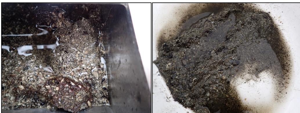
På stasjon **S3** fekk ein 21 m djup opp ca  $\frac{1}{6}$  med gulgrå og lukt fri prøve med fast konsistens. Prøven bestod av grov og fin skjelsand og sand med noko småstein og grus.
