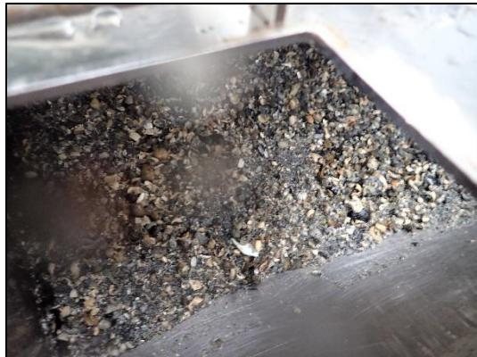
På stasjon **Aust 2** fekk ein frå mellom 2 og 3 m djup opp ca  $\frac{1}{6}$  grabb med gråe og luktfrie prøver med fast konsistens. Prøvene bestod av grov skjelsand på toppen og finare skjelsand under.
