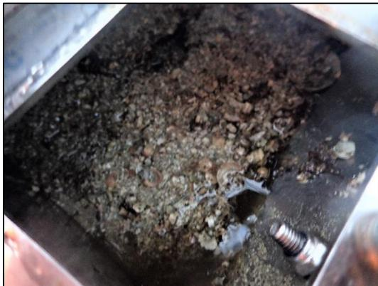
På stasjon **Sør 2** fekk ein frå ca 10 m djup opp ca  $\frac{1}{6}$  -  $\frac{1}{2}$  grabb gråe og luktfrie prøver med fast konsistens. Prøvene bestod av grov til fin skjelsand, og noko sand. Sedimentet var meir finkorna enn på Sør 1, og hadde nokon mørkare sedimentlag. Det var innslag av algar, sukkertare og kjerringhår i prøvene.
