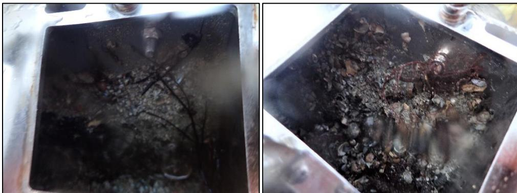
På stasjon **Sør 3** fekk ein frå ca 9 m djup opp ca  $\frac{1}{2}$  til  $\frac{2}{3}$  grabb gråe og luktfrie prøver med fast konsistens. Prøvene bestod av skjelsand og sand. Det var nokre mørkare områder i sedimentet.
