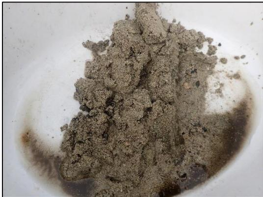
På **R5** fekk ein etter mange bomhogg opp tre vellykka prøvar. Ein fekk frå ca 62 m djup opp vel 1dl til vel  $\frac{1}{2}$  grabb ( 1- 5 cm) brungråe og luktfrie prøvar med mjuk til fast konsistens. Prøvane bestod av skjelsand og sand med noko silt og organisk materiale. Skjelsanden hadde noko varierende kornstorleik og ein prøve inneheldt noko grus.
