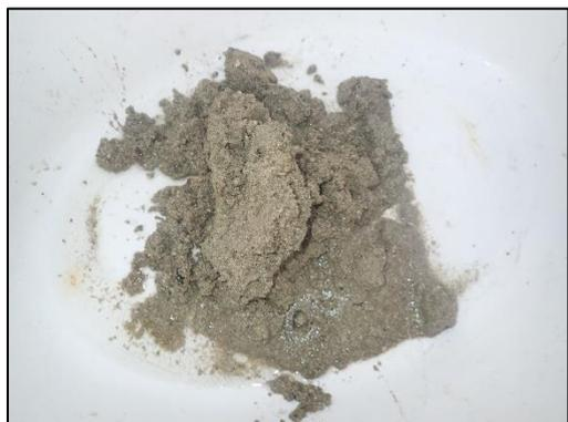
På **R3** fekk ein frå ca 35 m djup opp frå 1 dl til knapt  $\frac{2}{5}$  grabb (1-4 cm) gråe og luktfrie prøvar med fast konsistens. Prøvane bestod av skjelsand og sand. To av parallellane inneheldt også grus. Det vart tatt fem bomhogg og tre vellykka prøvar på stasjonen
