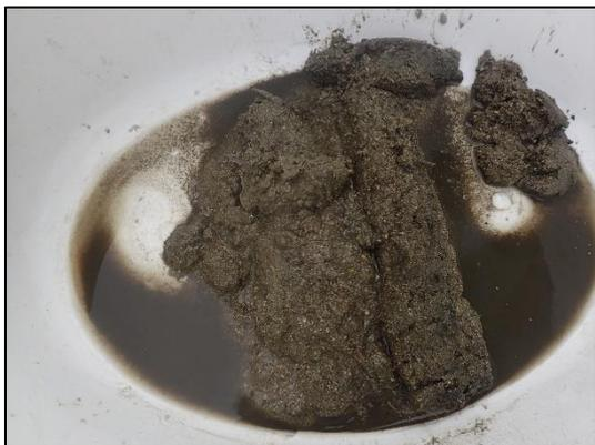
På **R6** fekk ein etter totalt 10 bomhogg opp to parallelle prøvar. Ein fekk frå ca 60 m djup opp tatt to vel  $\frac{1}{4}$  grabbar (3 cm) brune og luktfrie prøvar med mjuk konsistens. Prøvane bestod av sand, silt, skjelsand og grus.
