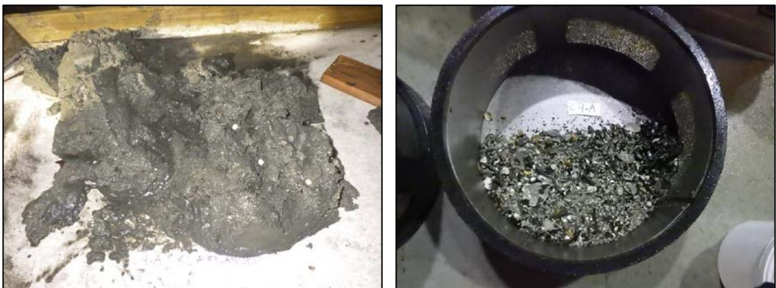
På stasjon **C5** fekk ein, etter tre bomhogg og flytting av stasjon, frå ca 235 m djup opp to vel  $\frac{3}{4}$  grabb (14 og 16 cm) grå, mjuk og luktfri prøve som bestod hovudsakleg av silt, med litt sand og leire. Dei to parallelle prøvane hamna i tilstand 1 = "meget god".
