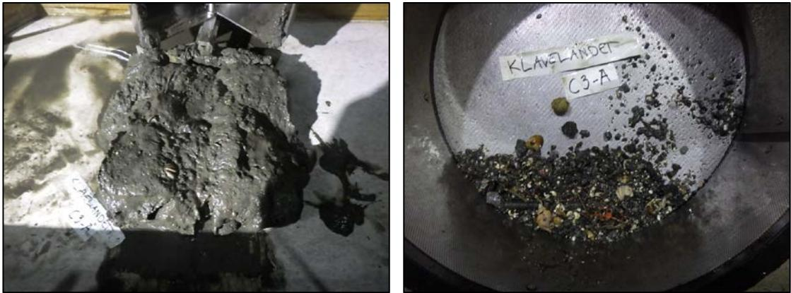
På stasjon **C4** fekk ein frå ca. 219 m djup opp knapt  $\frac{3}{4}$  til vel  $\frac{3}{4}$  grabb (13 og 15 cm) prøve. Ein prøve var gråbrun, mjuk og med antyding til lukt og bestod hovudsakleg av silt og skjelsand, med noko sand, litt mudder og spor av grus. Den andre prøven var grå, mjuk og luktfri og bestod hovudsakleg av silt med noko sand og spor av skjelsand og grus. Dei to parallelle prøvane hamna i tilstand 1 = "meget god".
