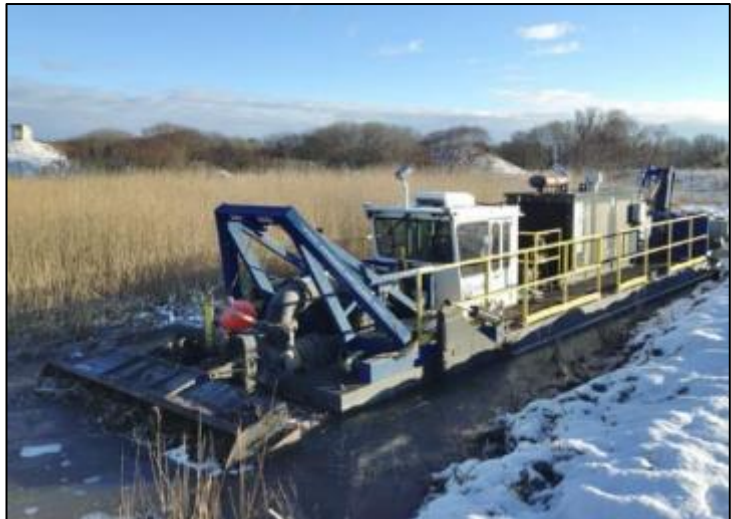
Figur 5. Versi dredge mudringsmaskin som ble satt inn i mudringsarbeidet ved Slevdalsvannet. Foto: Eivind Hellerslien. Bilde tatt fra Hellerslien (2016)
