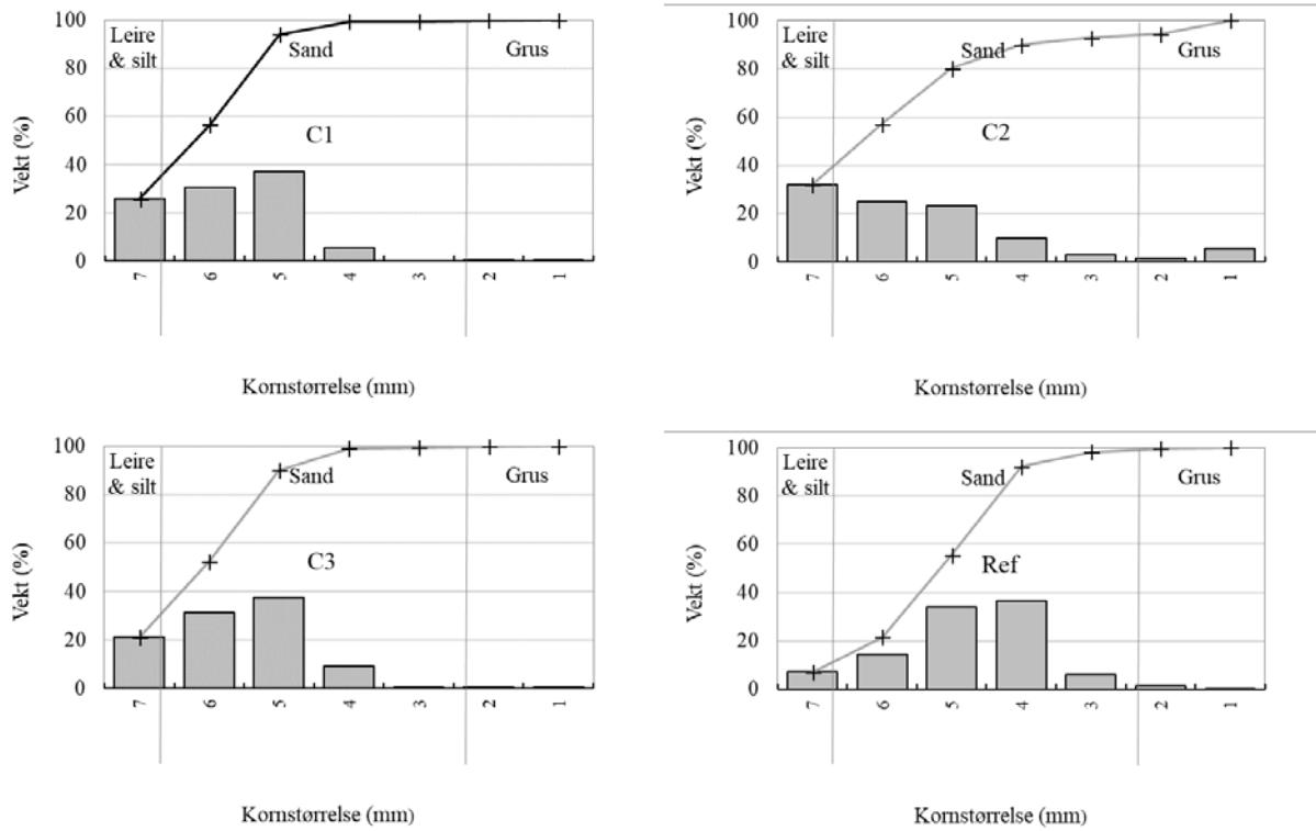
**Figur 5.** Kornfordeling i sedimentet på stasjonane C1–C3 og Ref fra granskinga i Dåfjorden 15. mars 2018. Figuren viser kornstørrelse i mm langs x-aksen og høvesvis akkumulert vektprosent (linje) og andel (stolper) i kvar storleikskategori langs y-aksen. Vertikale linjer indikerer grense mellom leire/silt og sand, og mellom sand og grus.
