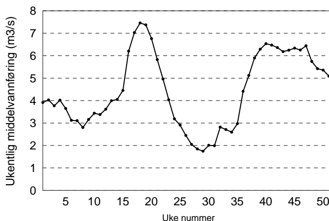
FIGUR 9: Teoretisk beregnet ukentlig middelvannføring i Nordelva. Beregningene er utført ved hjelp av NVEs "Lavanti-modell".
