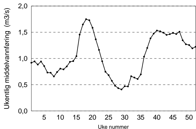
FIGUR 8: Teoretisk beregnet ukentlig middelvannføring i Tverrelva. Beregningene er utført ved hjelp av NVEs "Lavanti-modell".
