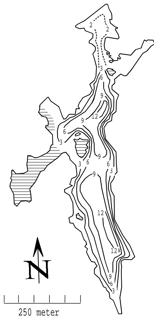
FIGUR 1.2. Dybdekart av Morlandsvatnet. Kartet er utarbeidet i forbindelse med denne undersøkelsen og er tegnet med 3 meters koter. For volumberegninger av innsjøen se tabell 1.2.
