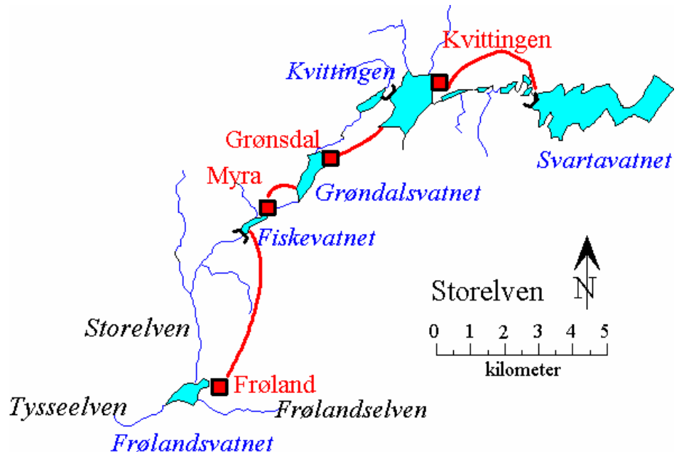
Figur 2. Reguleringane i dei nedre deler av Storelva. Kraftverka er synt med raude firkantar og raud skrift, medan inntaksmagasina er namngitt med blå tekst.
