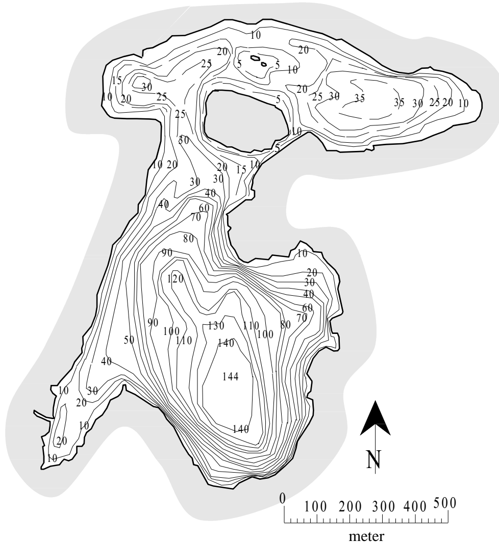
Figur 5. Dybdekart over Sørkvingevatnet, basert på opplodding utført 28.juni 1995. Dybdene er vist med heltrukne 10-meters koter, med stiplede hjelpekoter for hver femte meter enkelte steder (fra Johnsen 1995).
