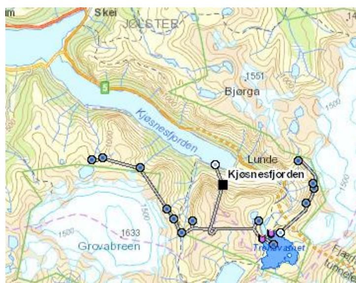
**Figur 2.1.2.** Kjøsnesfjorden med overføringer, magasin og avløp frå Kjøsnesfjorden kraftverk.
